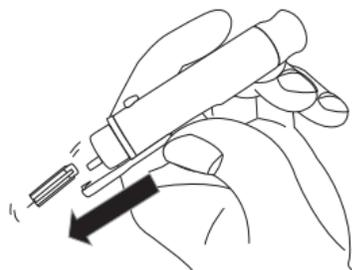
gleichzeitig die Spannhülse nach hinten um die gebrauchte Lanzette auszuwerfen. Entsorgen Sie die Lanzette ordnungsgemäß.
