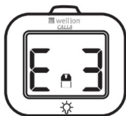
“Teststreifen wurde zu früh aus dem Messgerät entfernt”
