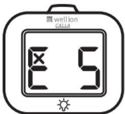
“Das Messgerät ist beschädigt”
