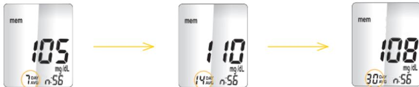
Die Zahl der Messungen, die zur Durchschnittsberechnung herangezogen wurde, wird rechts neben dem  $\text{DAY AVG}$  Symbol angezeigt. Kontrolllösungsmessergebnisse werden nicht in die Durchschnittsberechnung miteinbezogen.
